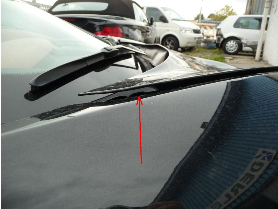
Bild 13: Scharnier v.r. Deckel v. verformt
