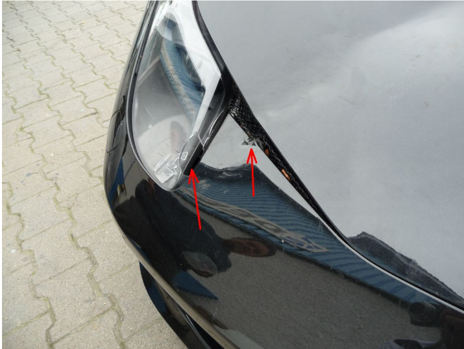
Bild 5: Stoßfänger v.r. und Scheinwerfer v.r. beschädigt
