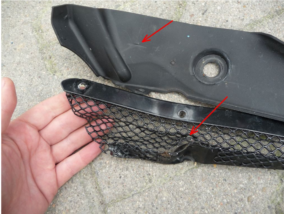
Bild 7: Gitter v.r. und Abdeckung verformt, verkratzt
