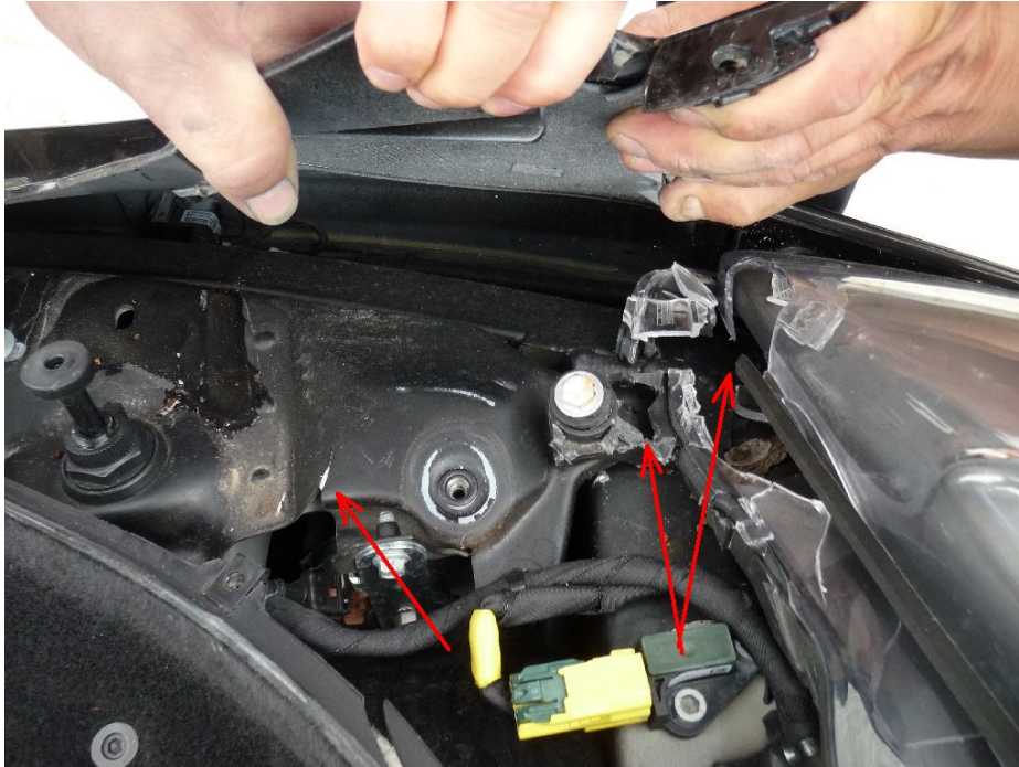
Bild 11: Frontmodul v.r. verformt, Scheinwerfer v.r. gebrochen
