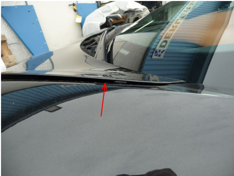
Bild 14: Scharnier v.l. Deckel v. verformt
