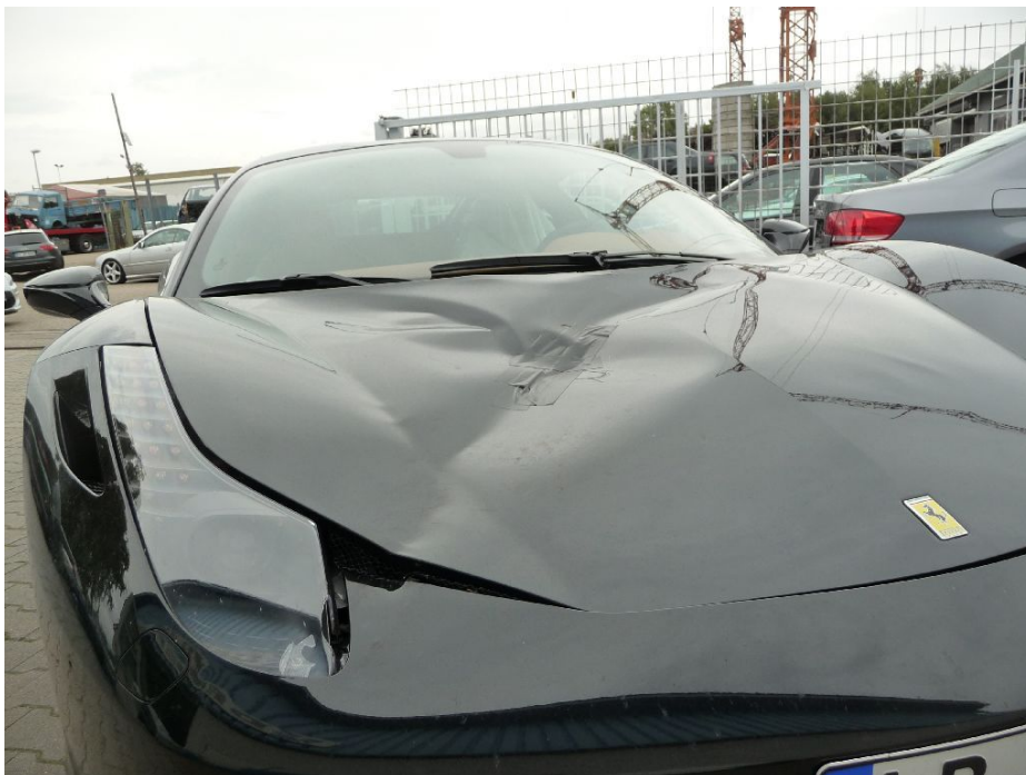
Bild 4: Klappe vorne eingedrückt, Scheinwerfer v.r. gebrochen
