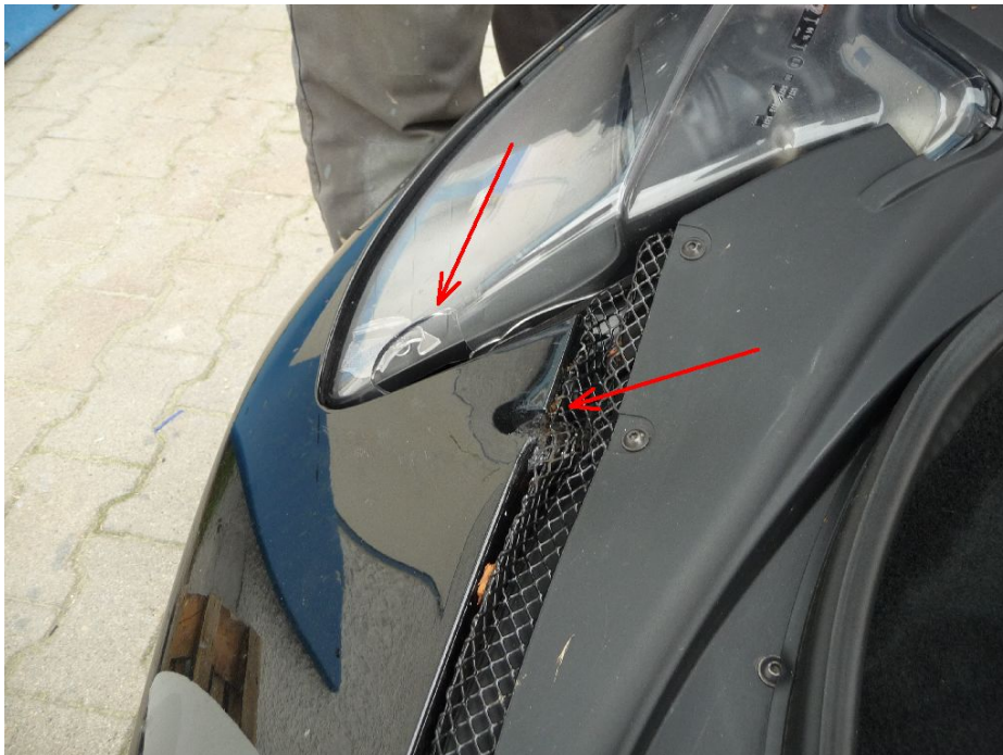
Bild 6: Stoßfänger v.r. und Scheinwerfer v.r. beschädigt
