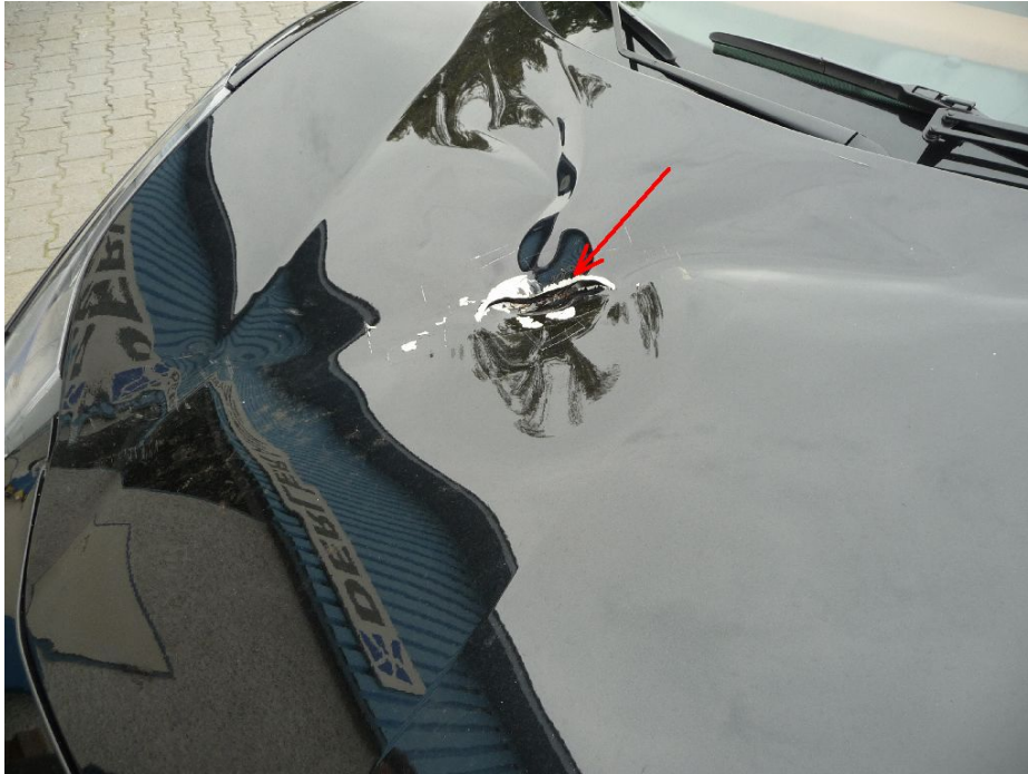
Bild 15: Klebeband Deckel vorne abgezogen. Loch im Deckel v.
