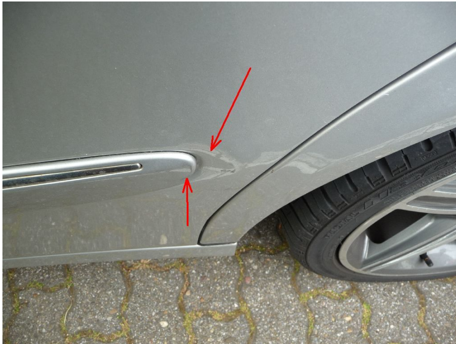
Bild 3: Tür h.l. eingedrückt + Kratzer, Kratzer Stoßleiste
