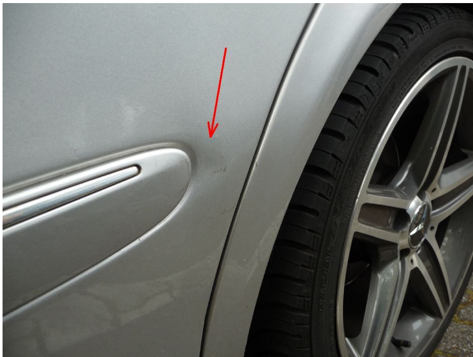
Bild 4: Tür h.l. eingedrückt + Kratzer, Kratzer Stoßleiste
