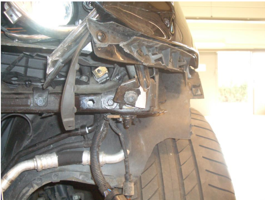
Bild 14: Div. Leitungen und Karosserieteile beschädigt
