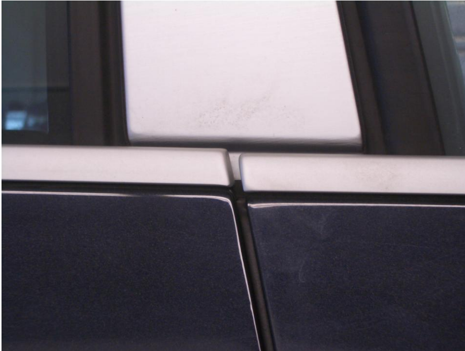
Bild 7: Tür vorne rechts zu tief
