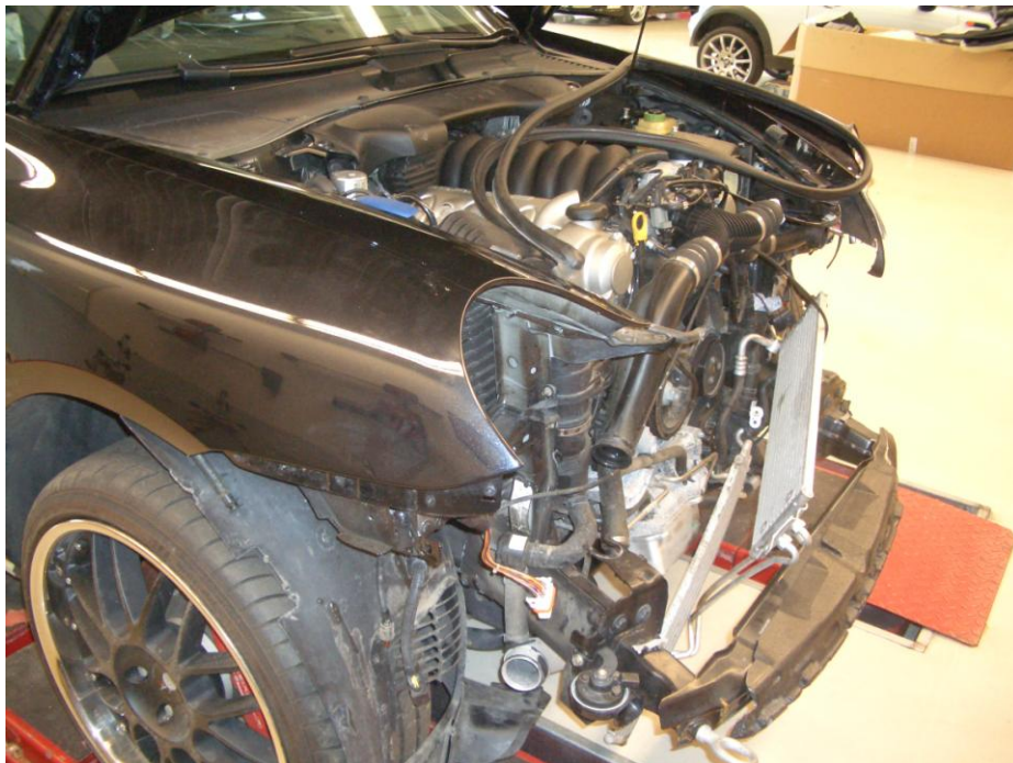
Bild 10: Fahrzeug vorne demontiert. Längsträger v. nach rechts abgeknickt.
