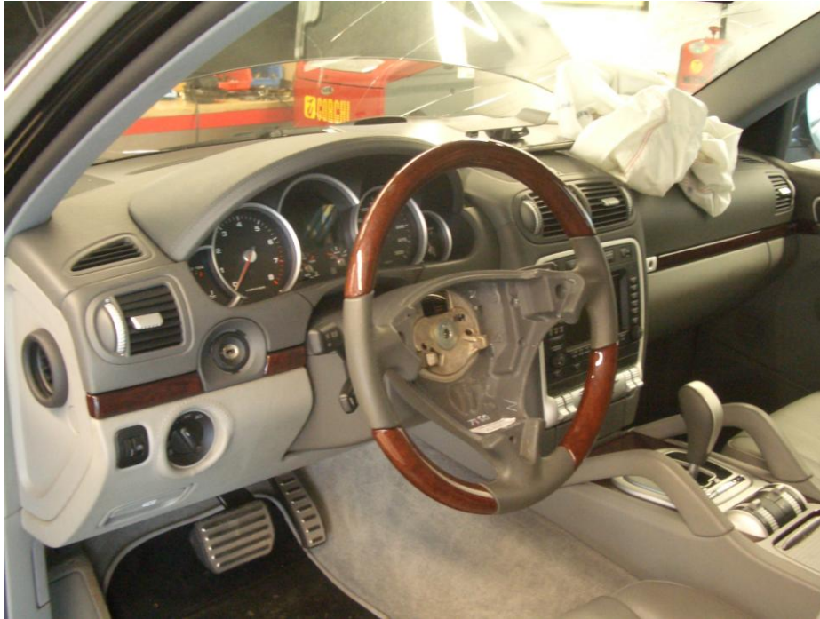
Bild 3: Airbag ausgelöst. Kombiinstrument durchgebrannt
