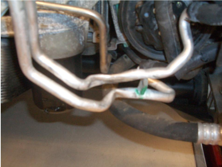
Bild 25: Leitungen Ölkühler besch.
