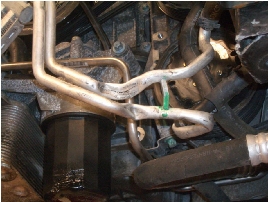
Bild 20: Div. Leitungen beschädigt
