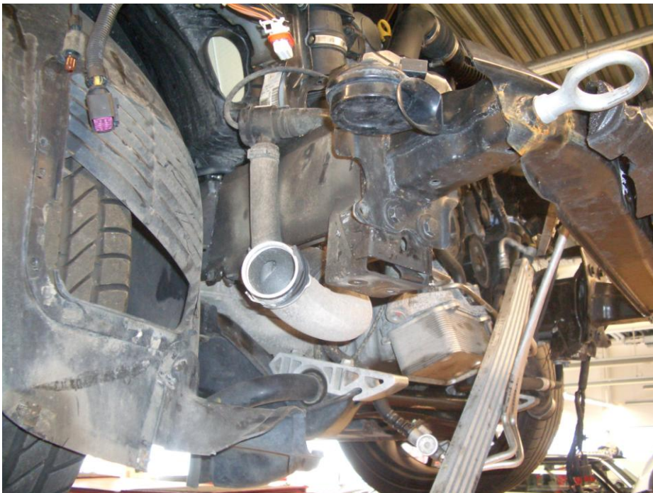
Bild 18: Ladeluftkühler gesplittert, Zuführung zum Turbolader/Ansaugtrakt offen
