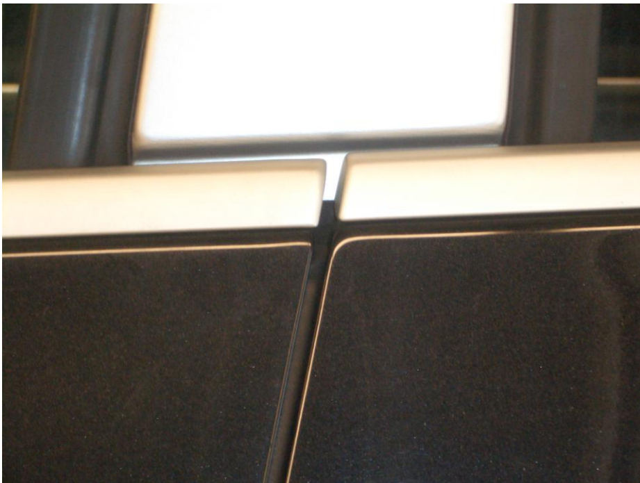
Bild 8: Tür vorne links zu tief
