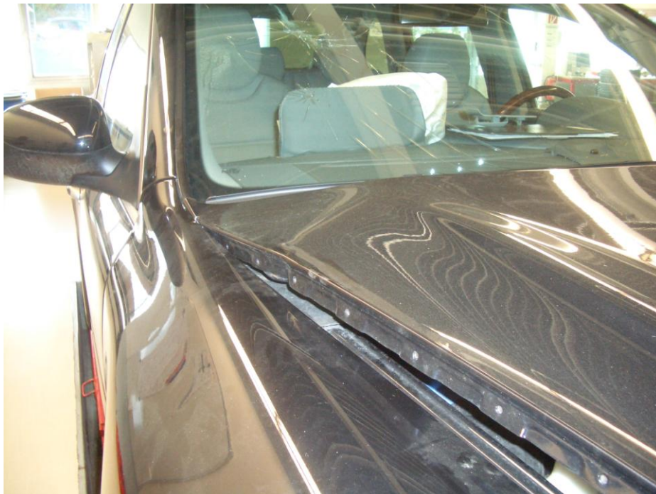
Bild 4: Motorhaube beschädigt. Windschutzscheibe beschädigt
