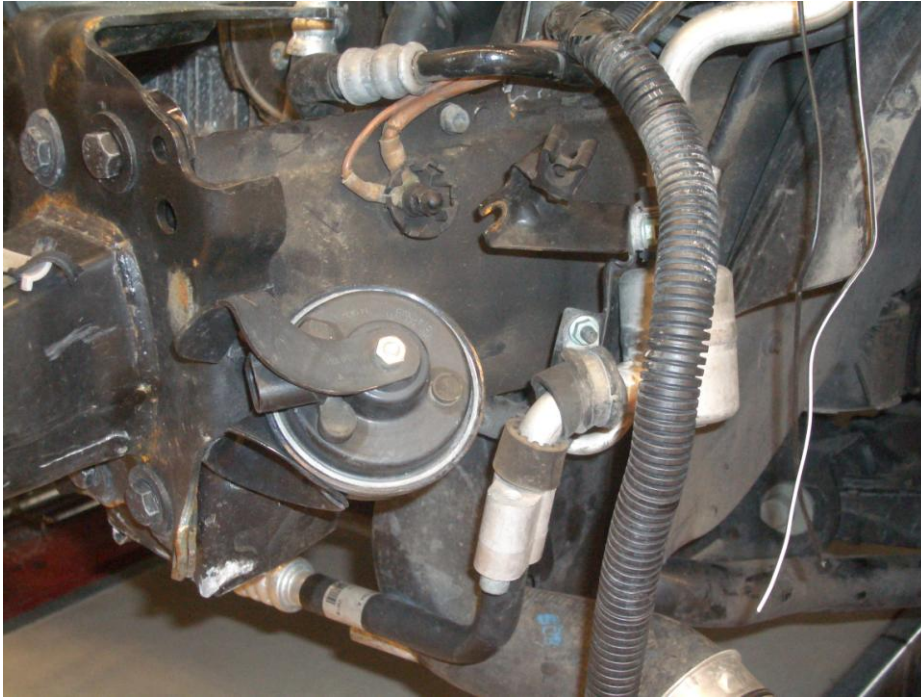
Bild 15: Hupe, Halter Klimaleitung etc. beschädigt
