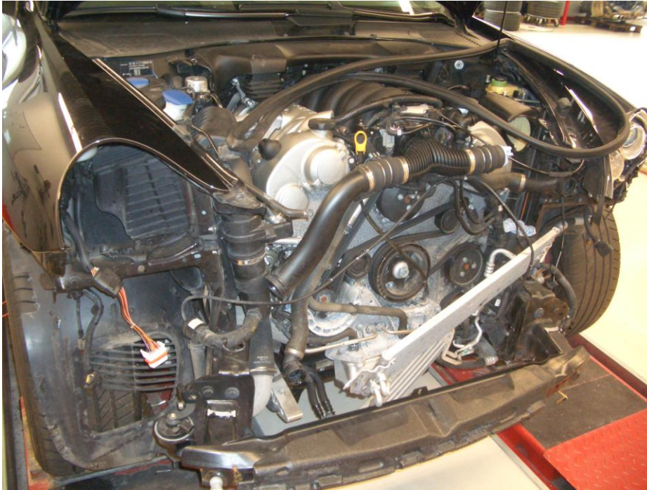
Bild 11: Fahrzeug vorne demontiert. Längsträger v. nach rechts abgeknickt.
